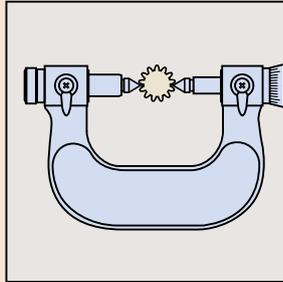
齿轮的测量钢球外点直径
