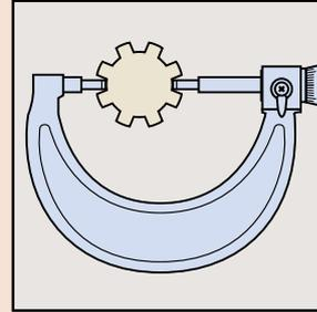
齿轮槽径测量
