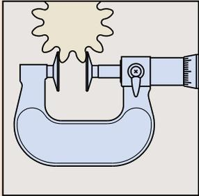
正齿和斜齿齿轮的跨齿长度
