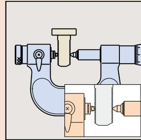
螺纹有效中径测量
